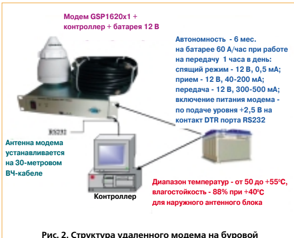
Рис. 2. Структура удаленного модема на буровой
